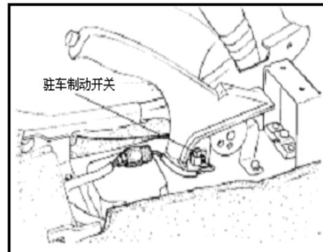
a、万用表的电阻通断档来检查手刹制动器上的开关是否出现故障。如开关故障，则进行更换；
