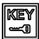
该指示灯用于提示 PEPS 的工作状态。该信号有 PEPS 发来的 CAN 信号。当该指示灯点亮或闪烁时，说明 PEPS 出现故障。先用诊断仪检测存在何种故障。
